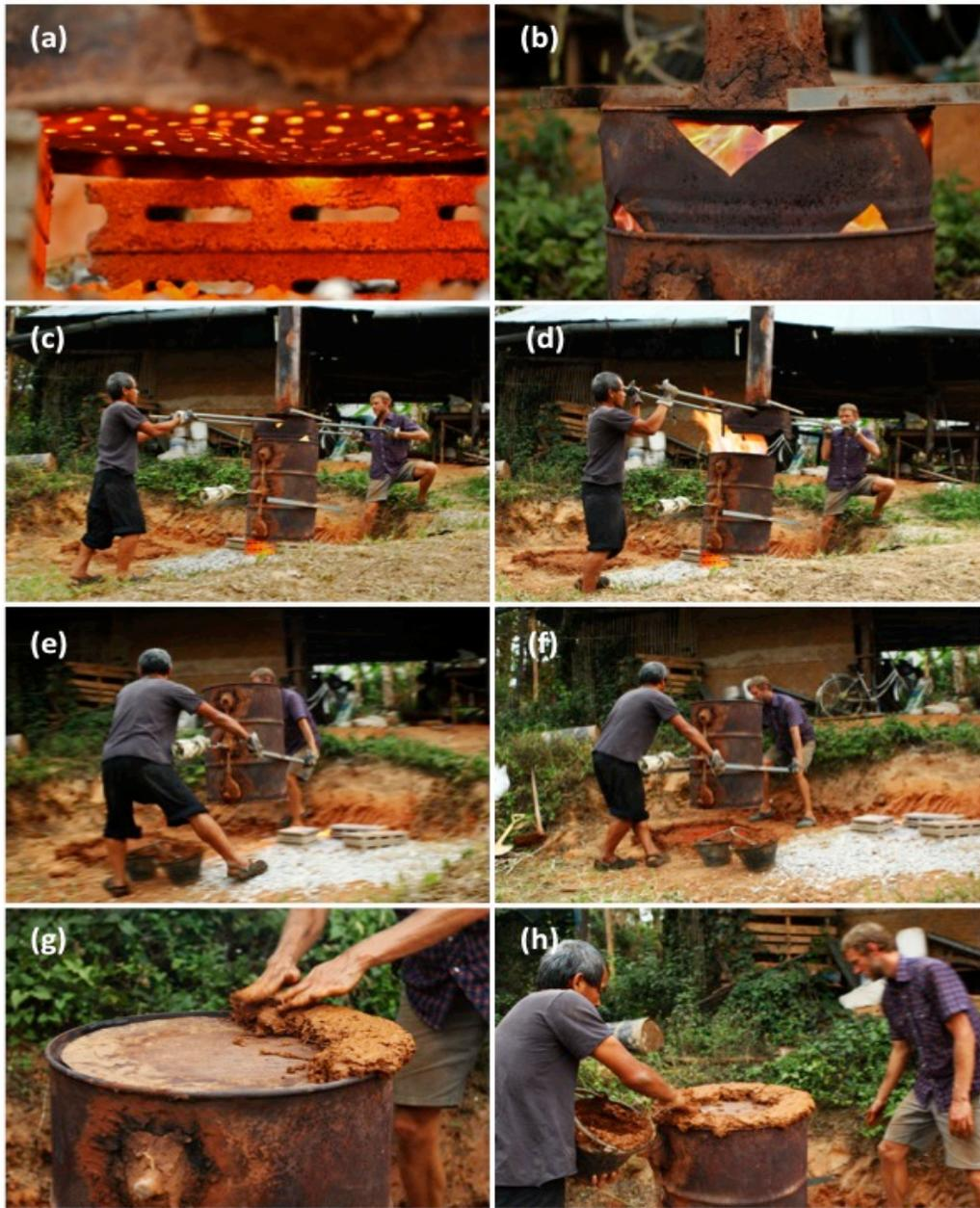
Fotos que muestra el procedimiento de apagado: El fondo del barril empieza a brillar (a) y las llamas azules aparecen en la corona (b), entonces la pirólisis está casi terminada. Retire la corona y la chimenea (c) y (d) poner la tapa y mover el cuerpo de reactor a la fosa de lodo al lado para sellar la parte inferior (e) y (f) sellar la parte superior con barro para prevenir fugas de aire (g) y (h). (Fotografía por Lyse Kong.)
