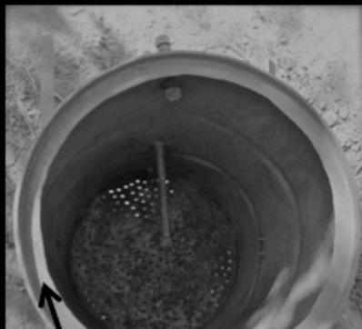
Borde de 5 cm en la parte superior del cuerpo del reactor
